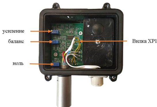
Рисунок Б.1 – Датчик МИГ-ТК-УВ с указанием элементов
